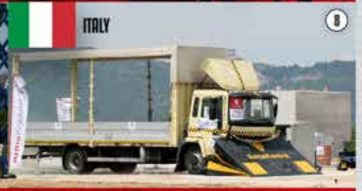
YÜKSEK GÜVENLİKLİ TELESKOPİK BLOK BARIYER 7500 KG / 80 KM
